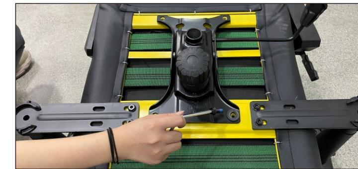
10 Закрійте механізм бічними накладками та закріпіть їх за допомогою гвинтів M5х8мм. Уникайте надмірних зусиль при затягуванні гвинтів, щоб не пошкодити пластик.
