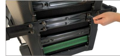
**8** Встановіть спинку крісла та закріпіть її за допомогою гвинтів M8x25мм. Одягніть на гвинти спочатку гровер, потім велику шайбу. Спочатку вкрутіть гвинти зі сторони правого шарніру, не затягуючи та унікаючи їх перекоосу. Після цього, вкрутіть ліву сторону та затягніть гвинти з обох сторін спинки.
